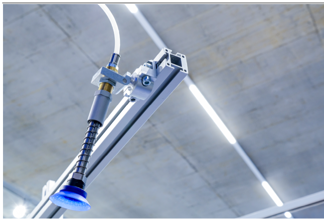
Конструкция системы Система держателей для держателя с шаровой головкой HP-HT
